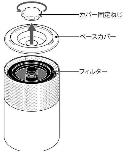
2. フィルターをポリ袋から取り出して、確実にセットし、ベースカバーを取り付け、カバー固定ねじで固定します。
