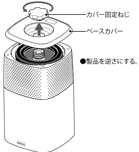
2. フィルターをポリ袋から取り出して、確実にセットし、ベースカバーを取り付け、カバー固定ねじで固定します。
