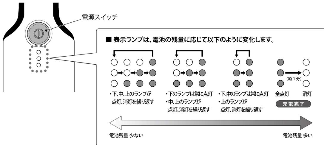
4. 充電が完了すると、3個全ての表示ランプが約1分間点灯し、その後消灯します。
